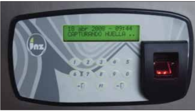
Bild 4. Dank Schnittstelle der Zutrittskontrolle (Fingerprint) zur KNX Anlage ist die bedarfsgerechte Steuerung und Regelung aller Anlagen möglich
